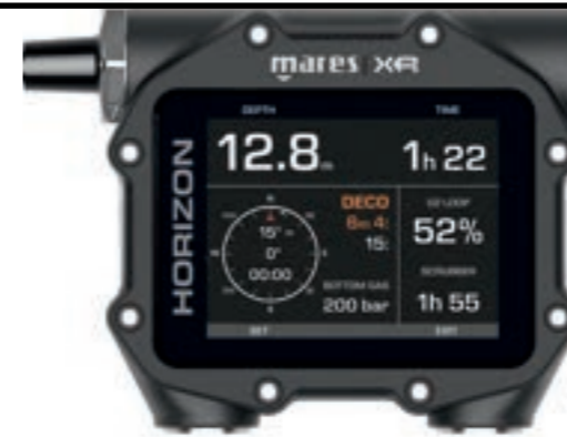
Der Computer des „Horizon“. Die „52%“ mittig rechts zeigen den O 2 -Anteil im Atemkreislauf an.
